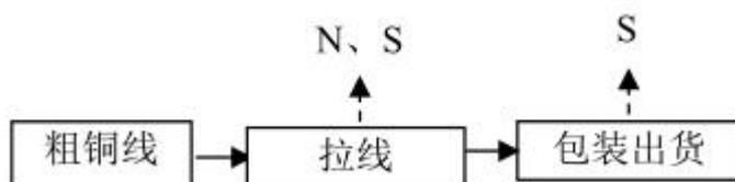
图 3-2 铜线生产工艺及产污环节图
